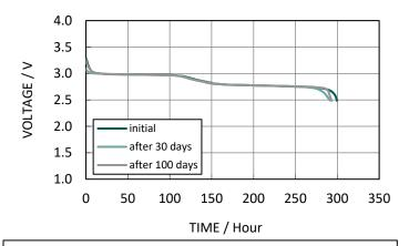
Charging Condition : CV(3.4V, 200 $\Omega$ , 48H, 60°C) Discharging Condition : CR(30k $\Omega$ , 60°C)
